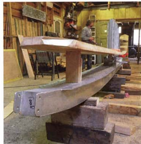
Detail van de rvs kiel en de kielbalk.
