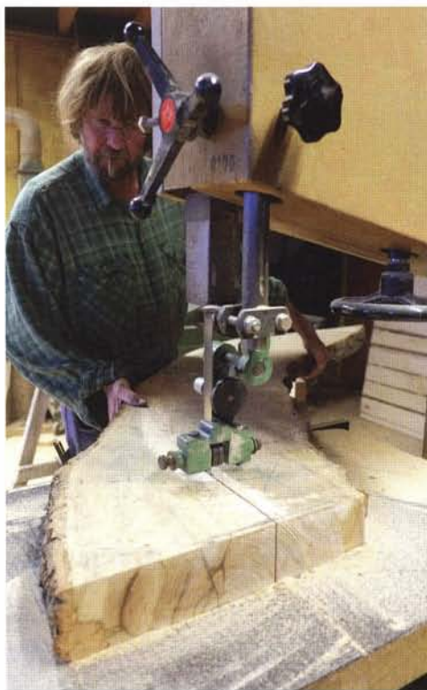
Peter Schouten zaagt een spant op de lintzaag uit een krommer.
